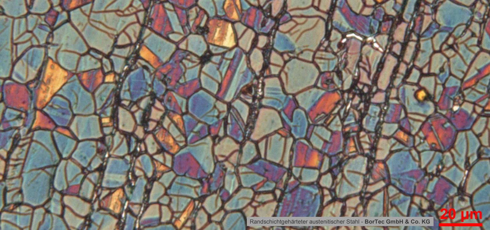
Randschichtgehärteter austenitischer Stahl - BorTec GmbH & Co. KG
